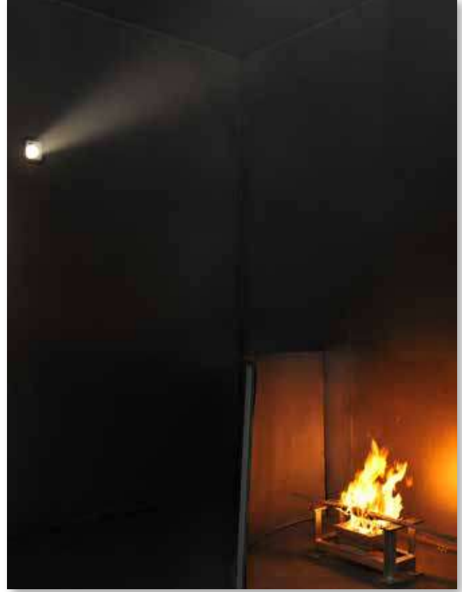
Duman yoğunluğu testindeki bir kablo numunesi.
