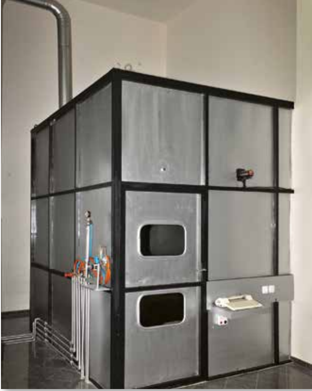
Duman yoğunluğu test kabini.
