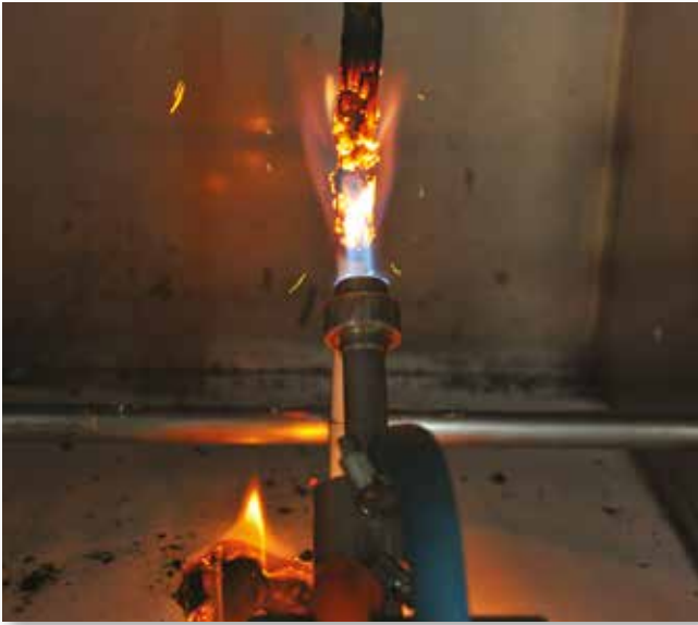
Yanan damlacık testindeki olumsuz bir kablo numunesi.
