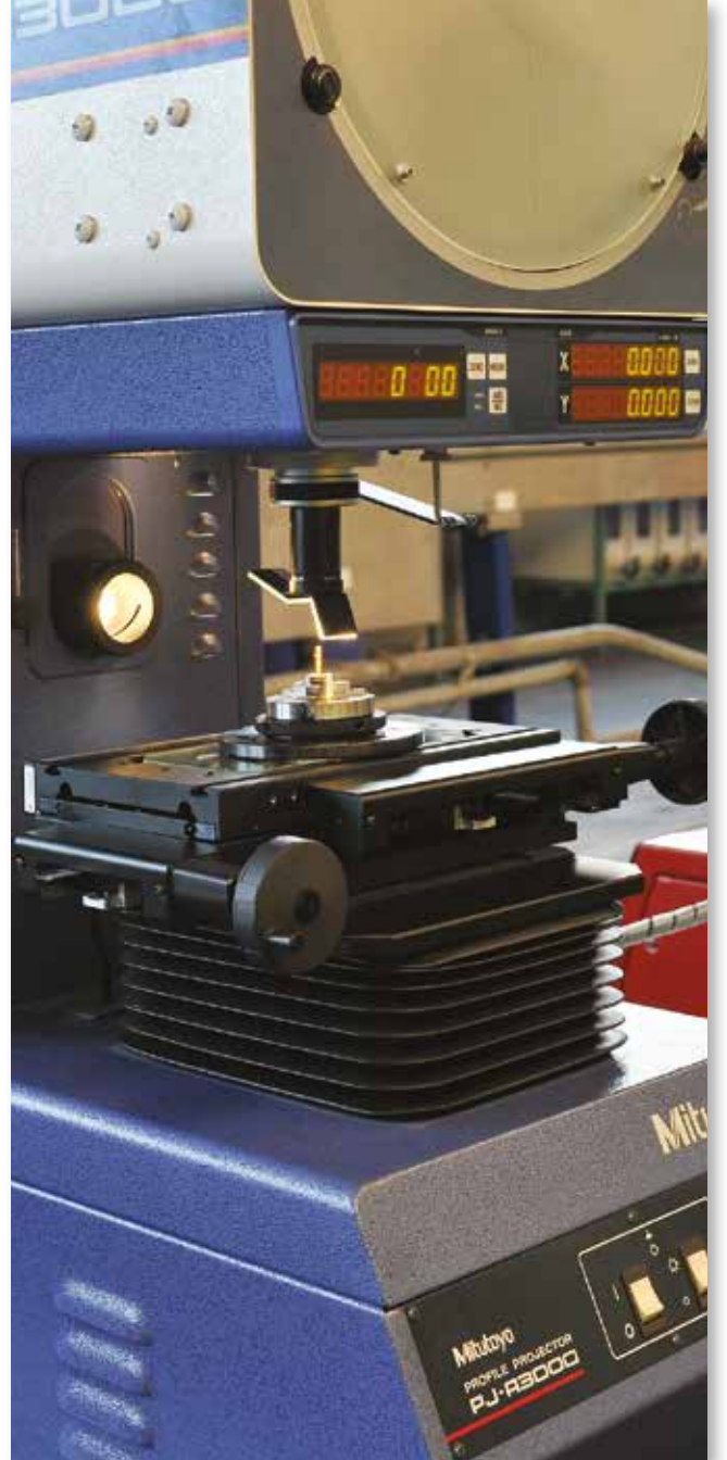
Profil projektör ile geometrik ölçümler yapılır.
