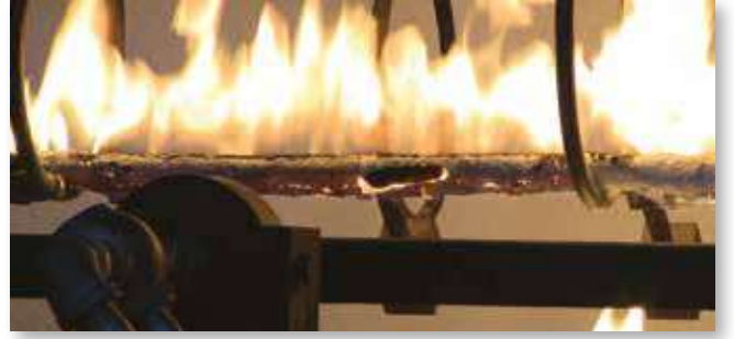
Test esnasındaki bir kablo, 3 saat boyunca gerilim taşımaya devam etmelidir.
