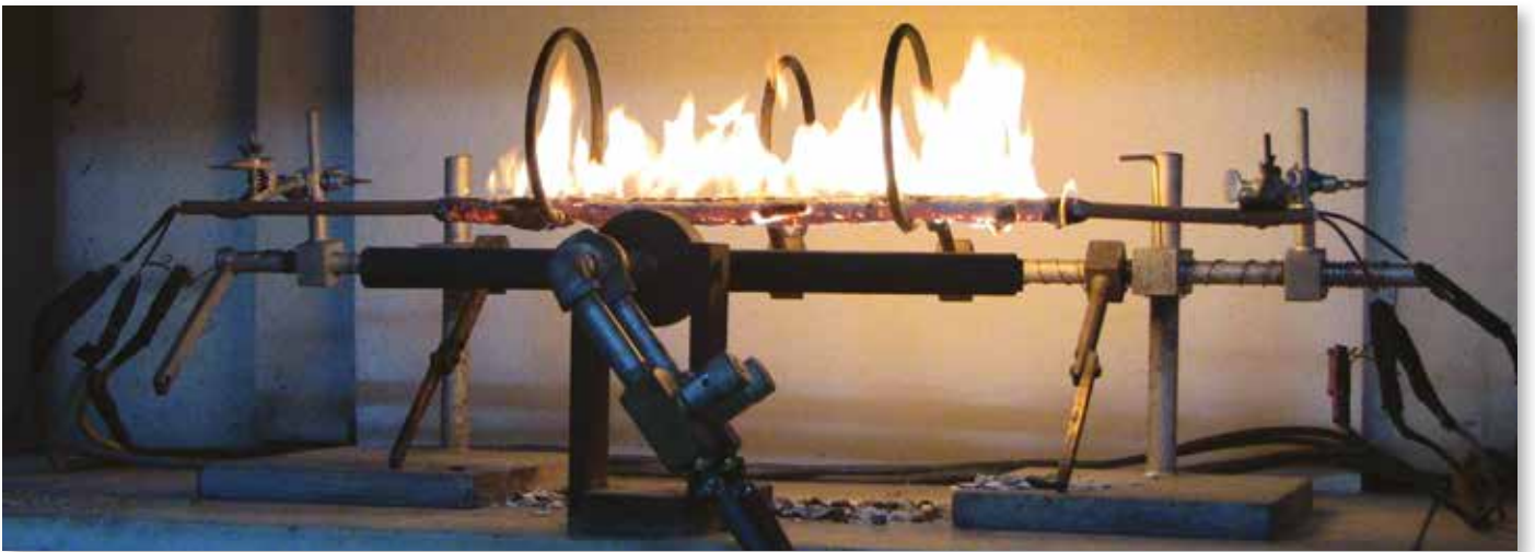
Gerilim altında yanma testindeki bir kablo numunesi.
