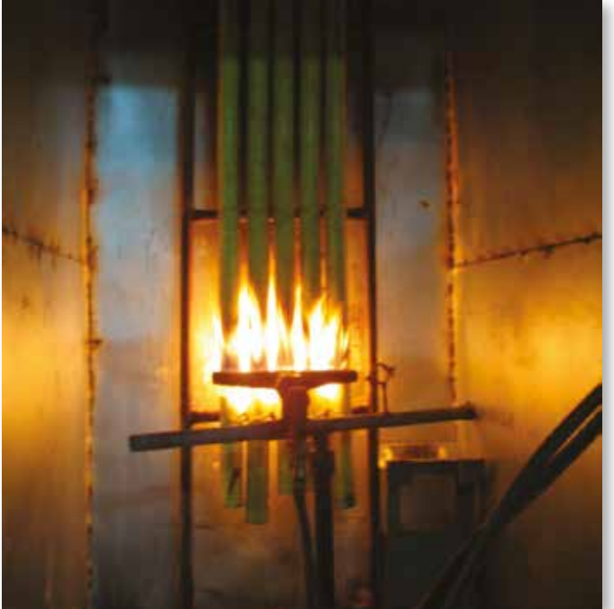
Demetlenmiş kabloların yanması testindeki bir kablo numunesi.
